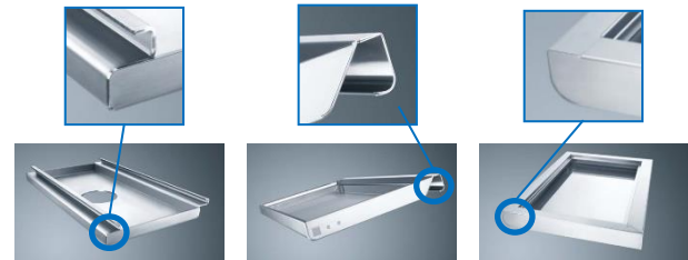
Şekil 3. Büküm merkezi ile gerçekleştirilebilen farklı panel tipleri
