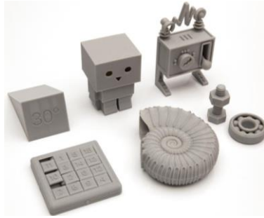
Şekil 7. FDM yöntemi ile imal edilmiş parçalar [31]
