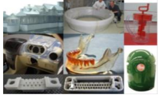
Şekil 5. SLA teknolojisi ile imal edilmiş parçalar [25]
