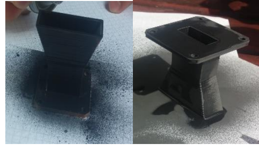
Şekil 3. Antenlerin 3B yazıcı ile üretimi
