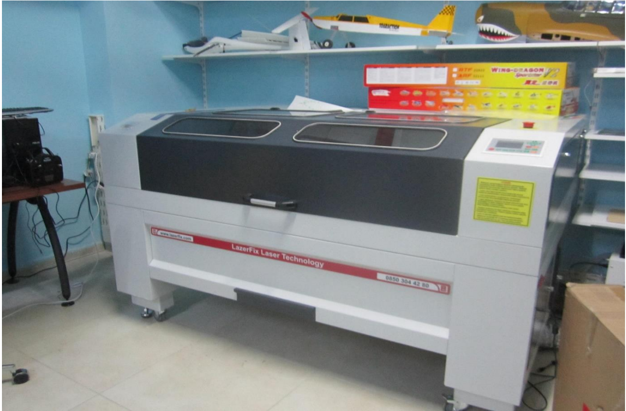
Resim 2: Hassas Lazer Kesim Cihazı
