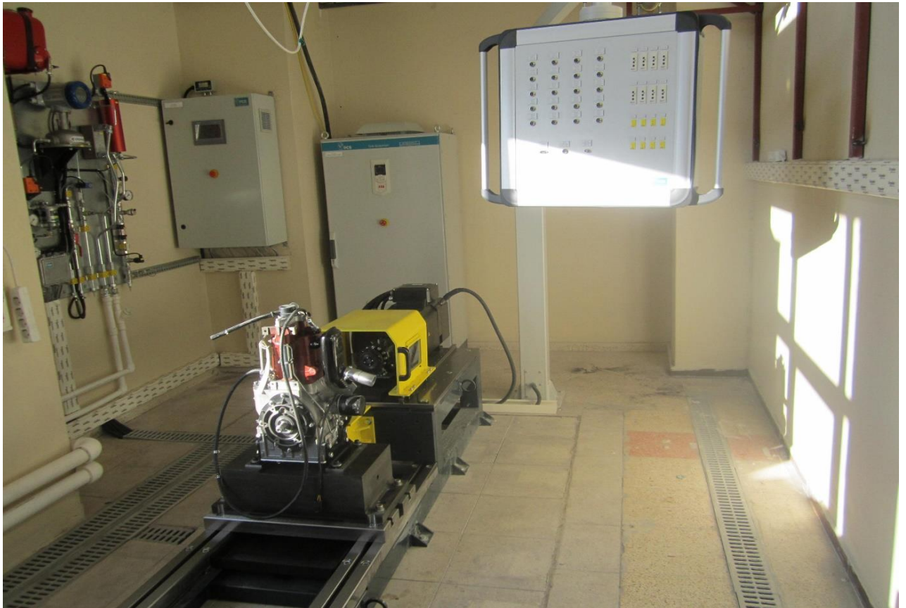
Resim 6: İçten Yanmalı Motor Test Sistemi
