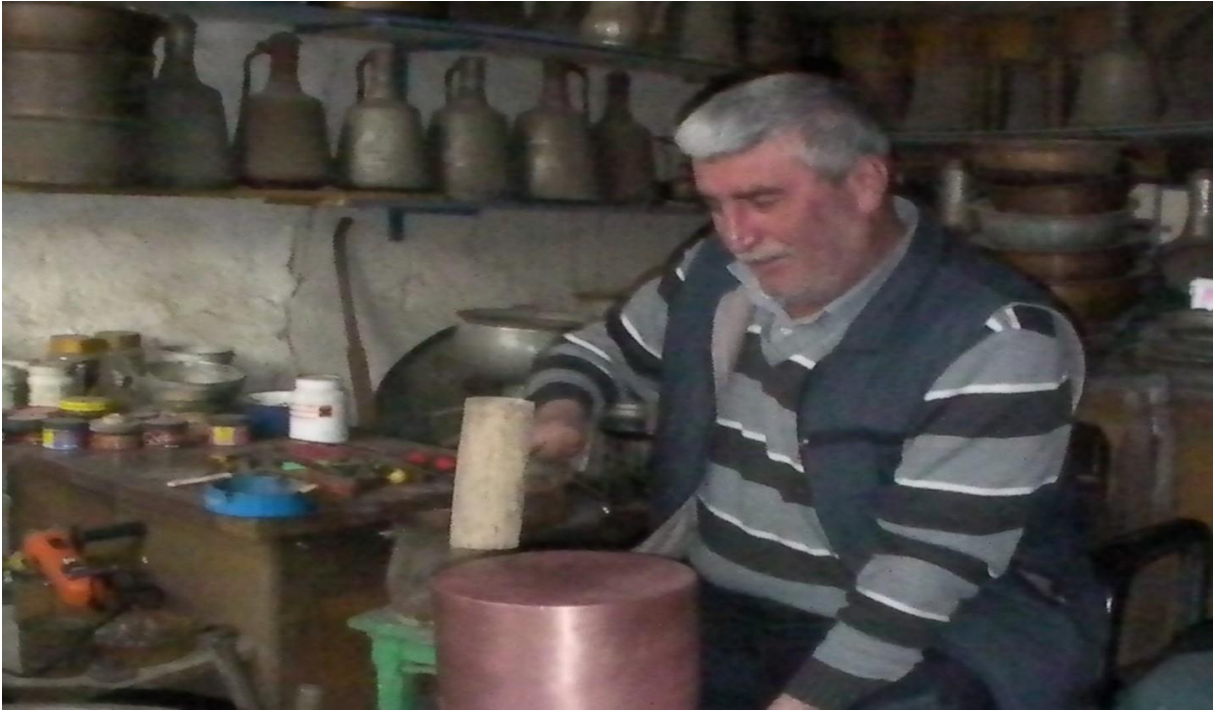
Fotoğraf 106: Kalay Yapılacak Tencerenin, Tokmakla Düzeltme İşleminde Bir Kare.
