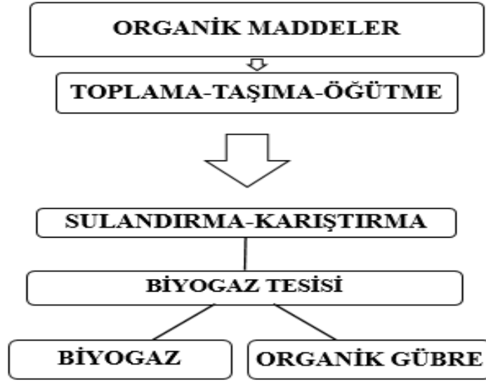
Şekil 2: Biyogaz ve Organik Gübre Üretim Akış Şeması
