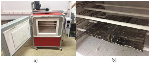
Şekil 2. Tavlama ortamı (a) PID Üniteli Fırın; (b) Deney ve Test Numuneleri
